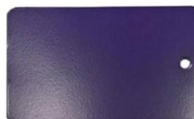
Les recommandations ci-dessus sont basées sur notre expérience avec RAPTOR et représentent seulement quelques exemples de textures pouvant être atteintes. U-POL recommande de faire un essai sur un panneau test pour s'assurer que la texture recherchée est obtenue.
