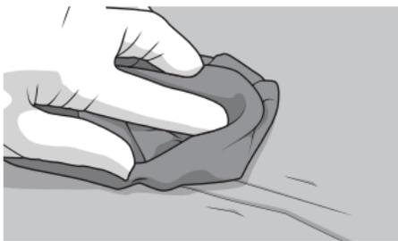
1. Portez des gants de protection, Enlevez les particules et dégraissez. La surface doit maintenant être propre, sèche et sans particules de peinture, ni rouille, sable et graisse.
