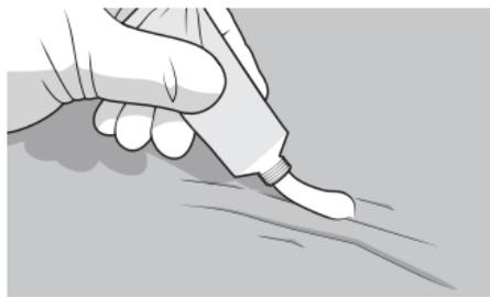
2. Ouvrez le tube et percez l'ouverture. Appliquez le Mastic pour Rayures et Projections de Gravillons directement à partir du tube sur la rayure, jusqu'à 1mm de profondeur. Remplacez le bouchon entre chaque utilisation pour préserver le produit.
