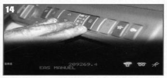
Il ne reste plus qu'à déconnecter la commande de suspension installée au niveau de la console centrale pour éviter que le voyant rouge indiquant un problème de suspension ne reste allumé. À chaque démarrage, l'ordinateur va indiquer «EAS manuel».
