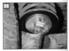
La partie inférieure se loge au niveau du pont. Le méplat de l'embase est dirigé du côté du moteur.
