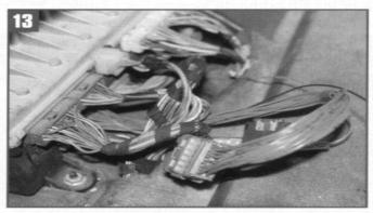
Pour éviter l'envoi d'un message de panne à l'ordinateur central, on installe le kit de connexion fourni sur le BECM qui comprend que la suspension est pilotée manuellement et le compresseur n'est plus activé.
